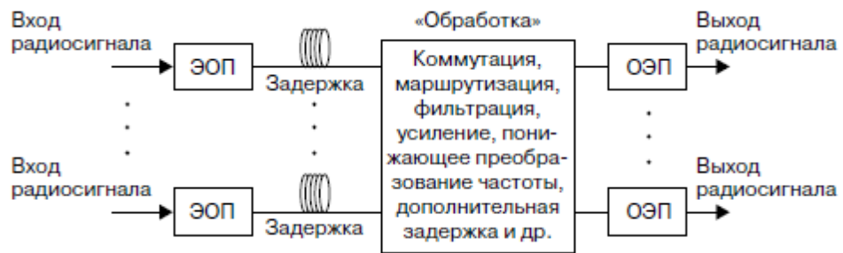
Рис. 6. Радиофотонный принцип построения РЭС
